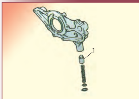
Σχήμα 26.8 Έλεγχος της βαλβίδας ανακούφισης.
