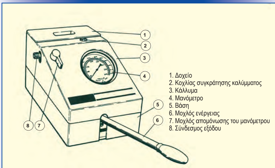
Σχήμα 37.2 Σύνθετη συσκευή ελέγχου εγχυτήρων
