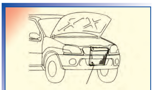
Σχήμα 29.1 Αποστράγγιση συστήματος ψύξης.
