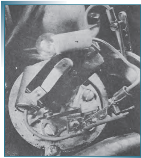
Σχήμα 23.2: Συνδεσμολογία δοκιμαστικού λαμπτήρα, παράλληλα με τις πλατίνες.
