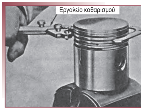
Σχήμα 10.3: Εργαλείο καθαρισμού των αυλακίων του εμβόλου.
