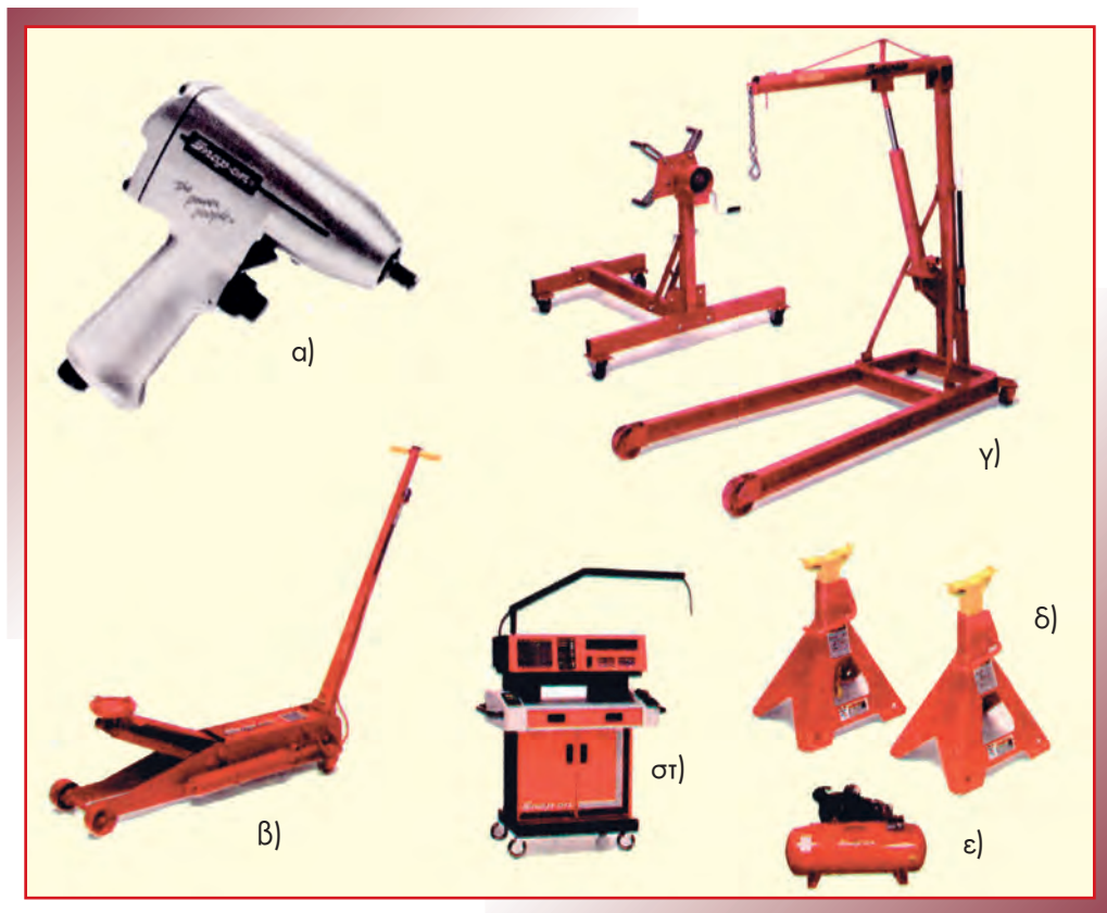
Σχήμα 2.3 Σύνθετες συσκευές και μηχανήματα: α) Αερόκλειδο, β) Γρύλος ανύψωσης, γ) Γερανός, δ) Τρίποδο, ε) Αεροσυμπιεστής, στ) Μηχάνημα ελέγχου λειτουργίας μηχανής
