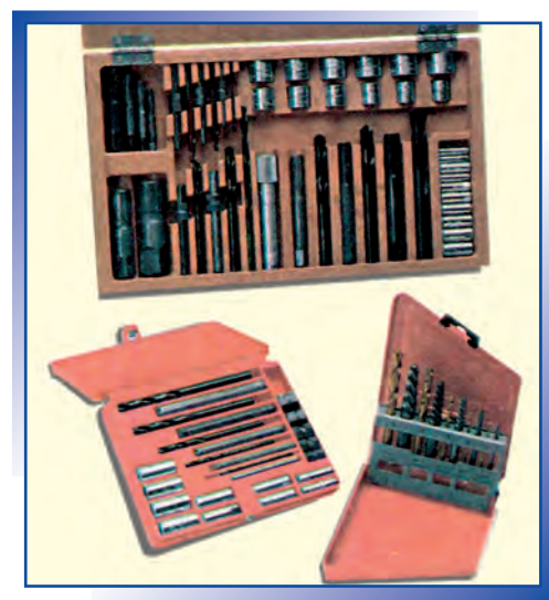
Σχήμα 5.3β Σειτ εξολκέων για σπασμένους κοχλίες
