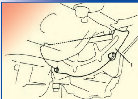
Σχήμα 25.10 Επανατοποθέτηση της κάτω πλάκα (1) του κελύφους του συμπλέκτη.
