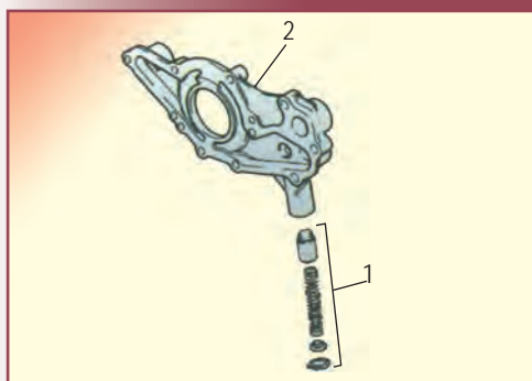
Σχήμα 26.12 Τοποθέτηση των εξαρτημάτων της βαλβίδας ανακούφισης στην πλάκα του ρότορα.
