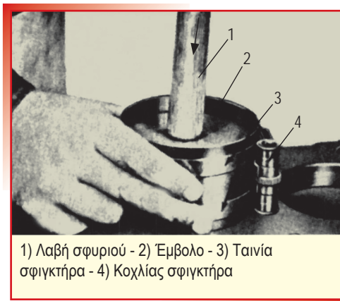
Σχήμα 12.2: Εισαγωγή του εμβόλου στον κύλινδρο με χρήση του ειδικού σφιγκτήρα (κολιές ελατηρίων).
