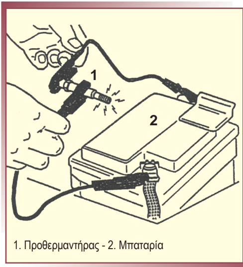
Σχήμα 42.7 Έλεγχος της διαδικασίας θέρμανσης του προθερμαντήρα
