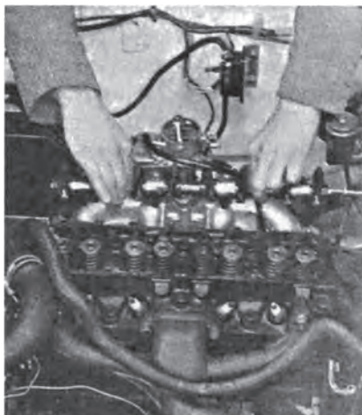
Σχήμα 15.8: Αφαίρεση του συγκροτήματος του πλκτροφορέα με τα έδρανά του.
